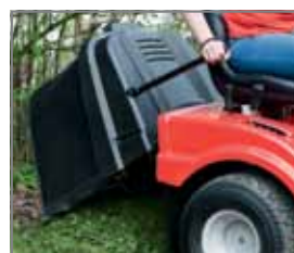
Большинство наших тракторов с задним выбросом позволяют опустошать травосборник не покидая водительского кресла
