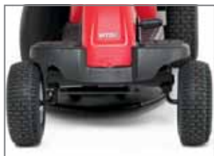
Дека с боковым смещением позволяет скашивать траву по краям участков
