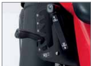
Высота кошения может быть установлена в одно из пяти положений от 38 до 95 мм
